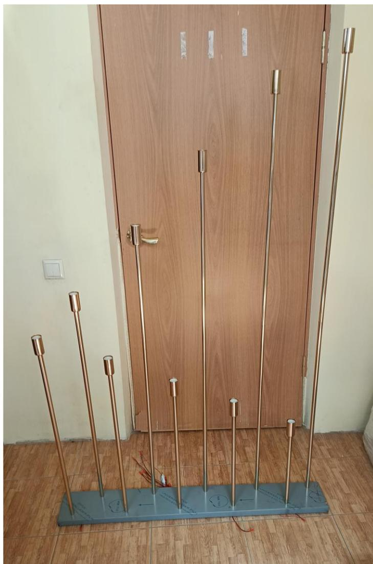
Шаг 4. Соединение проводов в основании. Соединяем провода из трубки с проводами в основании согласно полярности. Не имеет значение в каком порядке вы соедините провода. Ориентируйтесь на длину. К какому проводу достаёт провод из трубки с тем и соединяете.
