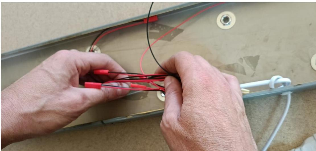
Возвращаемся к трубкам. Наша задача продеть провод из трубки через крепёж внутрь основания светильника.
