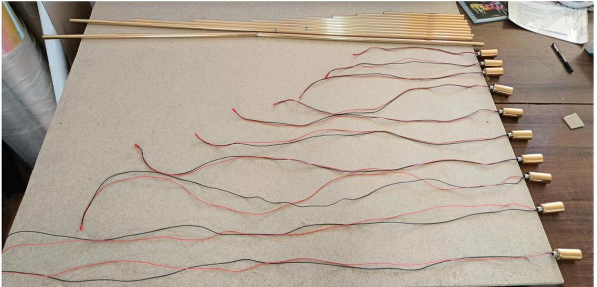
После чего продеваем провод в самую трубку и закручиваем патрон
