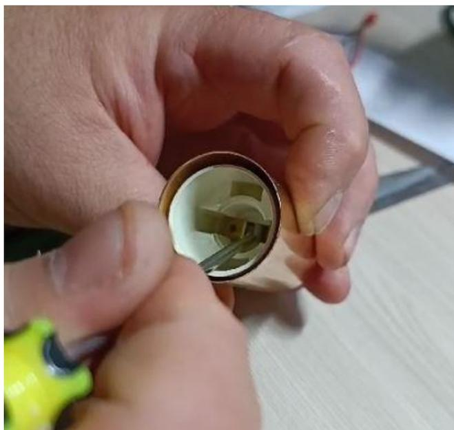
При необходимости язычок с одной стороны нужно приподнять, с другой – прижать до состояния с примера выше.
