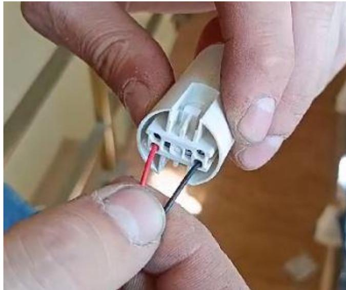
Провода внутри фиксируются и плотно держатся
