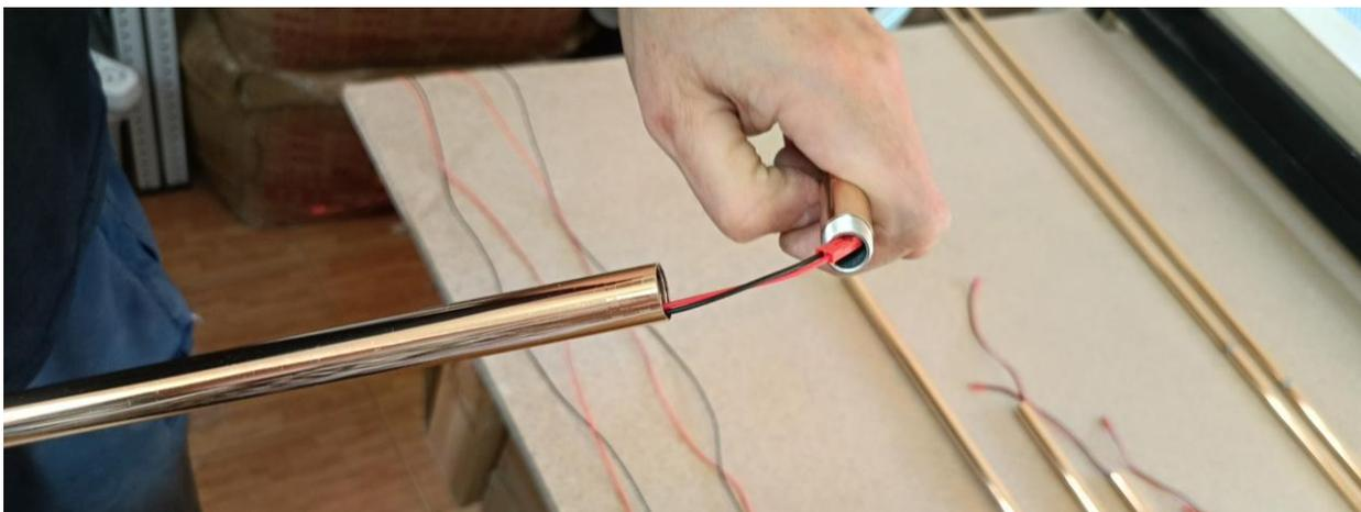
В сборной трубке лучше сначала пропустить провод через место соединения составных частей, а уже после закрутить их.
