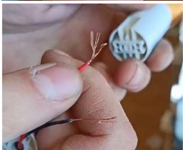
Достаем провода. Они сидят плотно, при необходимости их нужно выдернуть.
